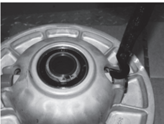
Hakenende des Werkzeugs einführen.
